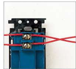
開關僅使用兩條訊號線連接。此兩條訊號線為無極性，因此不易發生施工上的錯誤。
