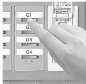
3 按下想要設定的群組開關。(開關上方的LED由綠燈切換成紅燈。)
