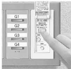
2 按下設定按鈕，將系統切換成設定模式。(紅色LED亮)。
