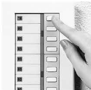
5 按下個別開關以確認要受到群組控制的負載。 LED (紅) on: 開關受群組控制 LED (紅及綠) off: 開關不受群組控制。
