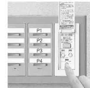
4 在執行初始設定之前，請先按下重置控制按鈕。(紅色LED亮)。 註：若您正在確認或執行變更，切勿執行此步驟4。
